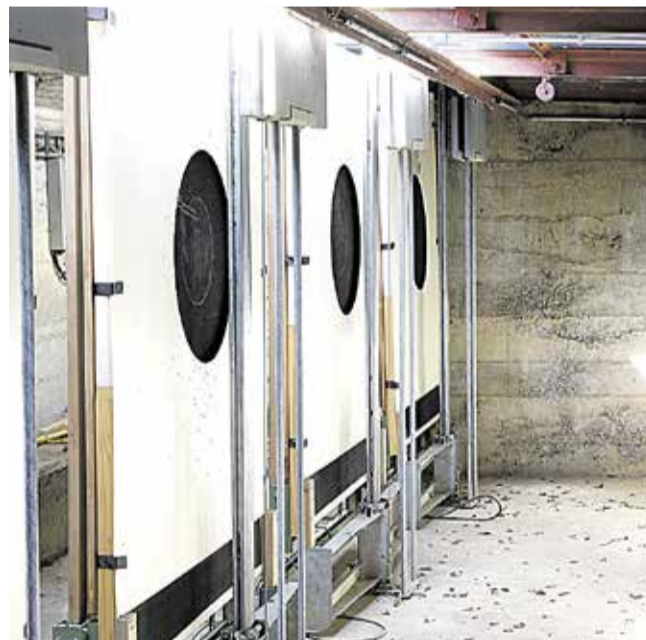
Blick auf die Rückseite der Scheiben im Scheibenstand. Gut zu sehen sind auch die Vorrichtungen, über die die Scheiben für Schiessanlässe aus dem Graben hochgefahren werden.
