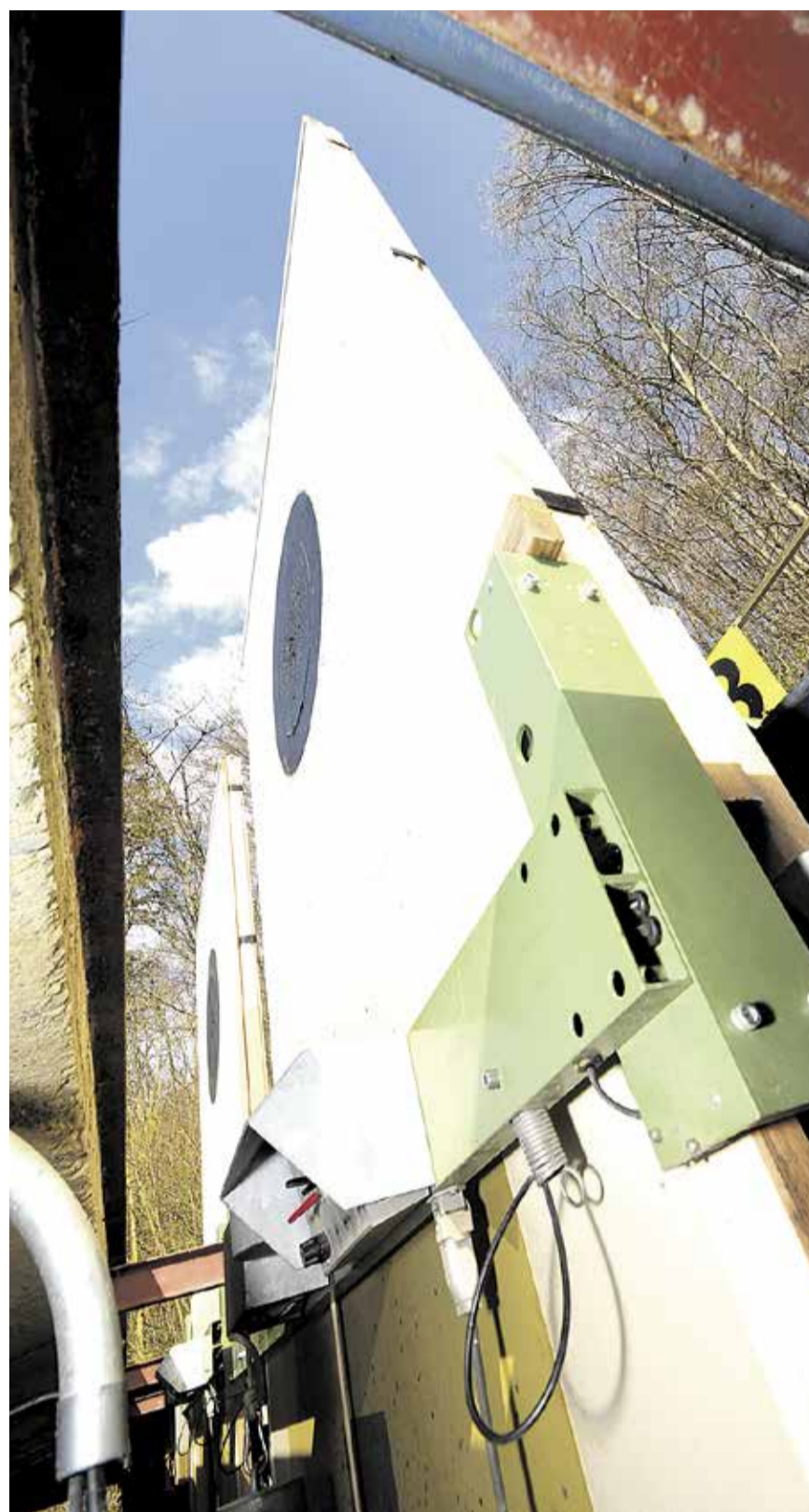
Heute müssen die Scheiben nicht mehr von Hand hochgestossen werden. Ferngesteuert und mit Hilfe eines Motors werden die A- oder B-Scheiben automatisch hochgefahren.
